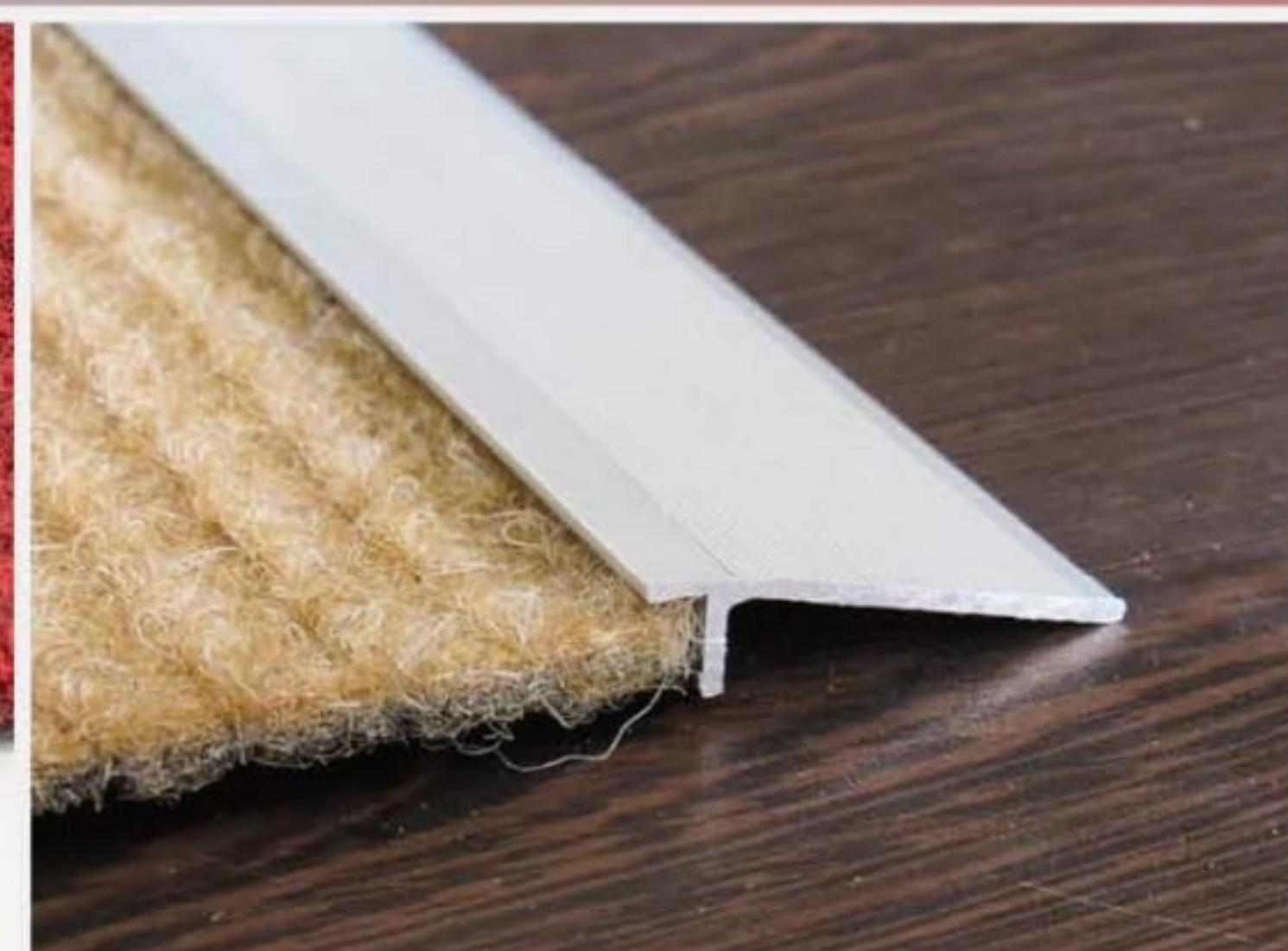
پروفیل آلمینیومی سپری شیبدار با ارتفاع ۱ سانتی متر برای از بین بردن اختلاف ارتفاع بین دو سطح استفاده میشود به این صورت دیگر محل پاگیر نخواهد بود پروفیل های شیبدار باز را میتوان با استفاده پیچ و رول پلاک نصب کرد
