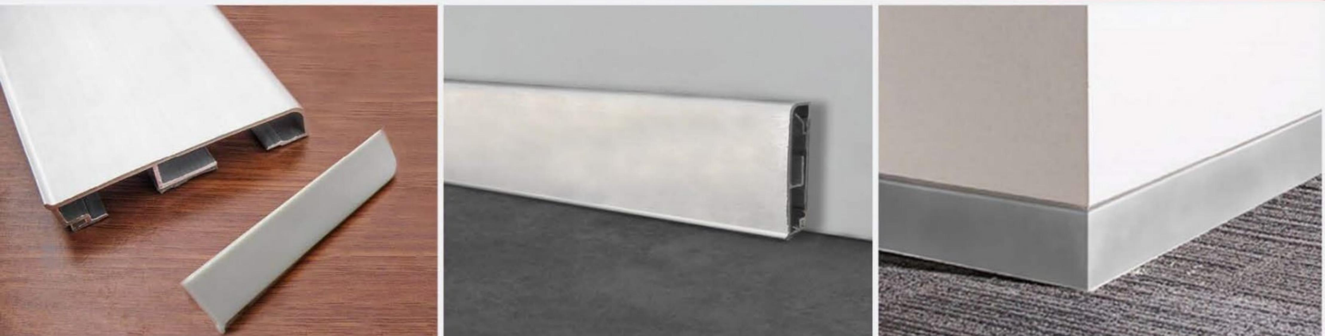
قرنيز آلومنيومي با تجمع خواصقرنيز آلومنيومي و داکت قسمت جدا نمودن انواع کابل ها و سيم کشي ها طراحی شده که دسترسی سریع و آسان به سيم کشي را برای شما فاهم میکند با نصب ساپورت یا پایه نگه دارنده با پیچ و رول پلاک به دیوار میتوان قرنیز را به صورت کشوی روی آن نصب کرد این قرنیز بیشتر در دفاتر و ادارات و همچنین مدارس و دانشگاه ها و فضاهای تجاری مورد استفاده قرار میگیرد
